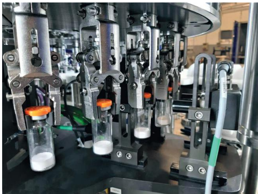
Abbildung 3: Top-Grip-Prinzip und HSA-Kontrolle.
