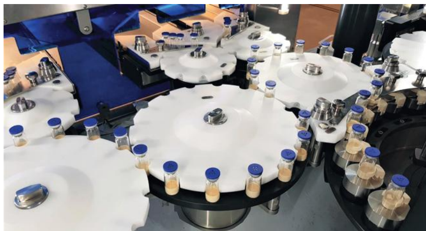
Abbildung 2: Transport in der LYO-CHECK-Anlage ohne äußere Führungen.
