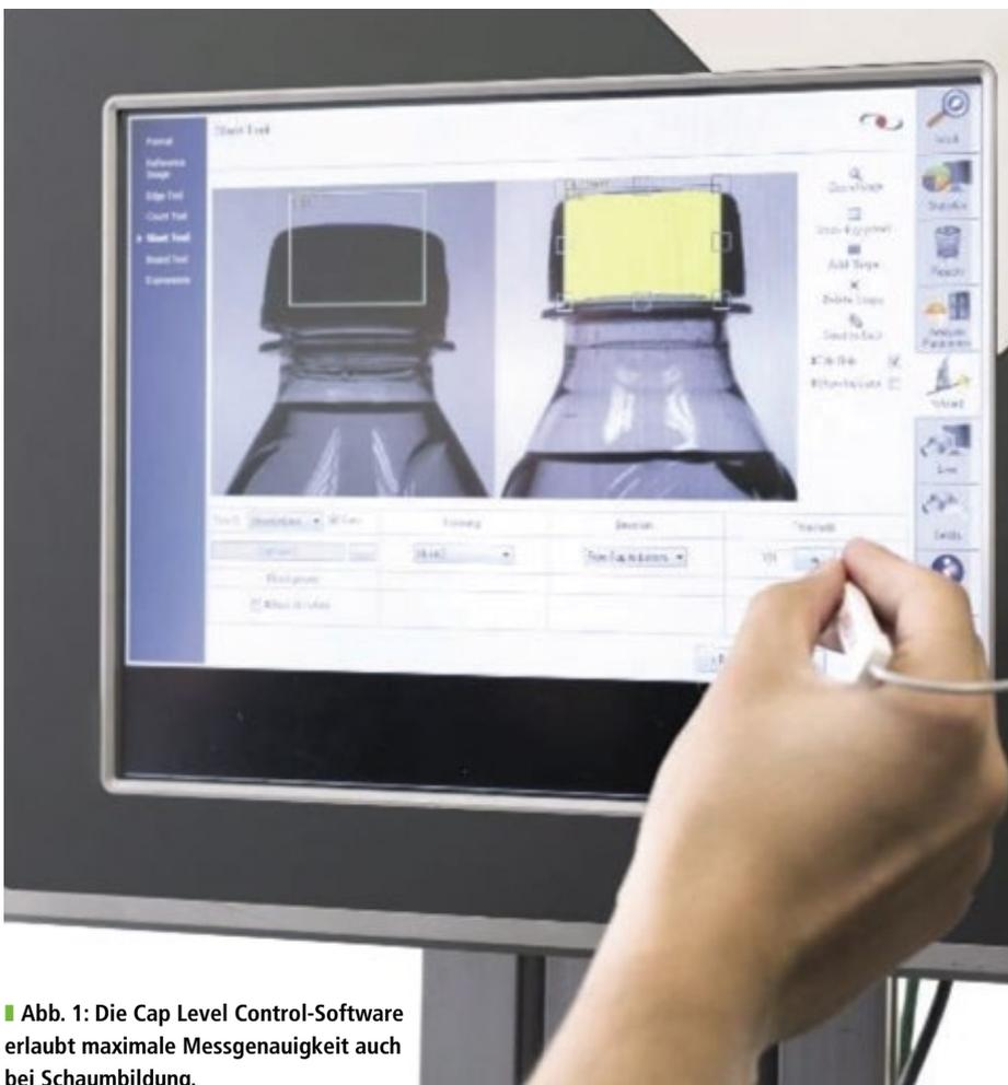
■ **Abb. 1:** Die Cap Level Control-Software erlaubt maximale Messgenauigkeit auch bei Schaumbildung.
